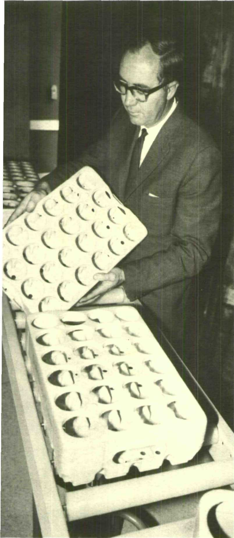
صناديق مصنوعة من اللدائن تمتاز بخفة وزنها، وهي مصنوعة من البوليثيلين ذي الكثافة العالية
