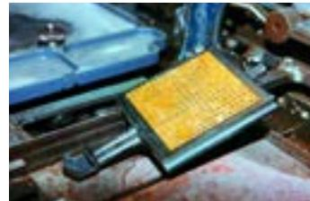
◀ في الصورتين الأذئتين بعض كليشات أرامكو التي لا تزال تحتفظ بها «المطبع»، ويبيو حولها مجموعات من أحرف الرصاص التي تم سكها لاستخدام على جهاز «مونوتايب»، وهي الصورة الثالثة يظهر جهاز «ماترييس»، الذي كان يستخدم في سلك حروف الرصاص التي تستخدم في الطباعة على جهاز «مونوتايب».
