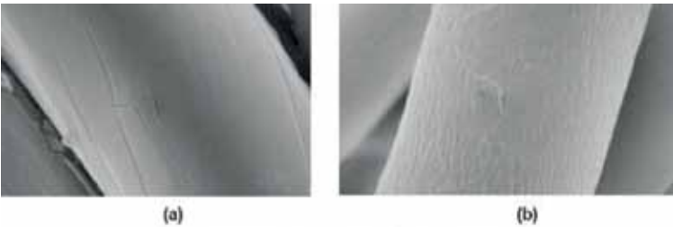
صورة من نسيج تمت معالجته بمادة ثاني أكسيد التيتانيوم النانوي ونسيج آخر من دون معالجة نانوية، والفرق يوضح أسباب عدم وصول الأشعة الضارة إلى الجسم بسبب طبيعة الطبقة النهائية وخواصها العاكسة للضوء الضار.
