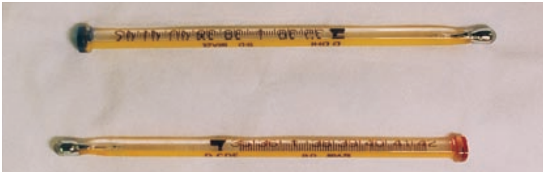
تقوم فكرة الترمومتر على أساس تمدد حجم السوائل بزيادة درجة الحرارة
