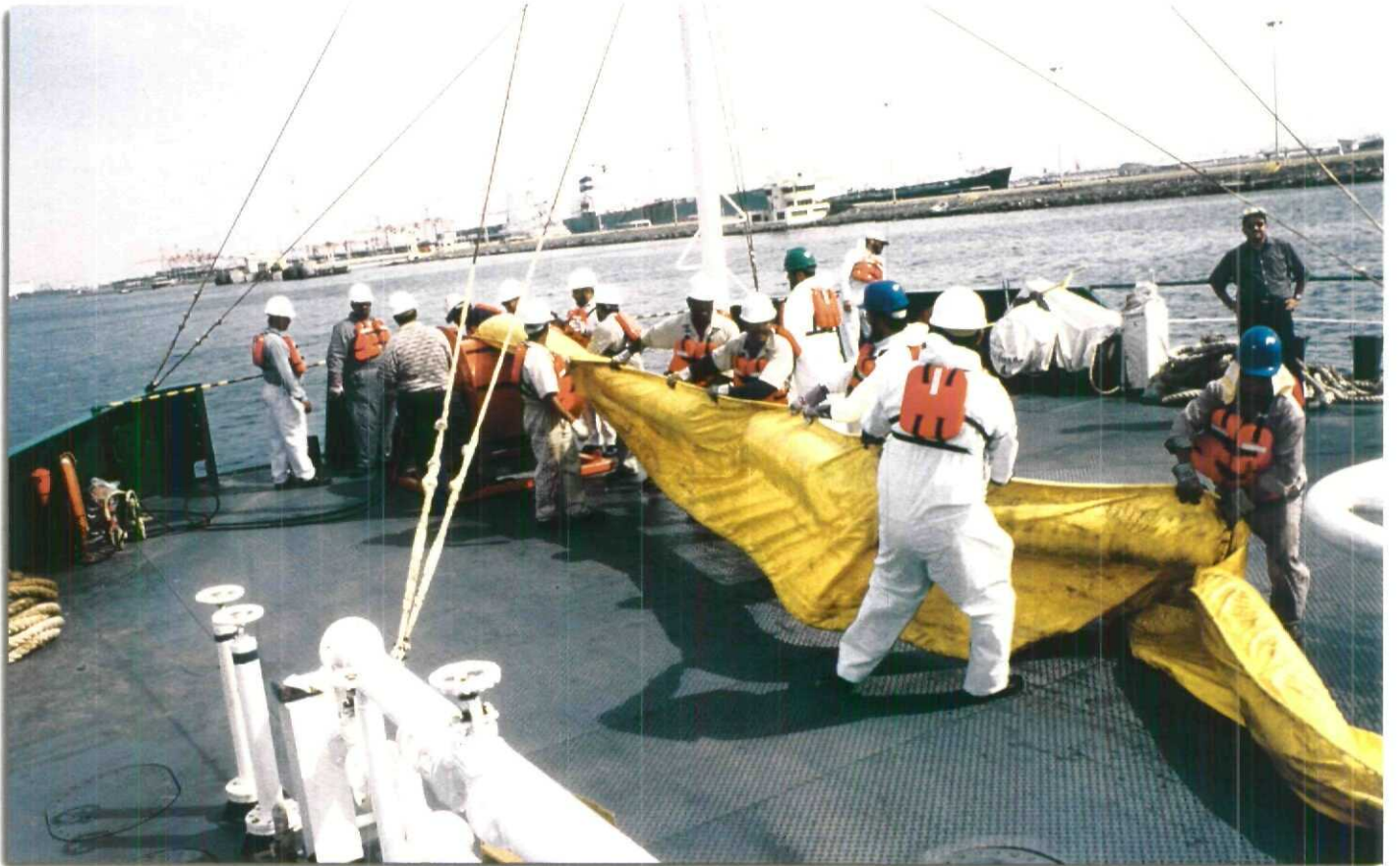
إخصائيو الاستجابة لحالات انسكاب الزيت في الشركة يقومون باستخدام أطواق احتجاز الزيت أثناء تمرين أجلي مؤخراً في جدة
