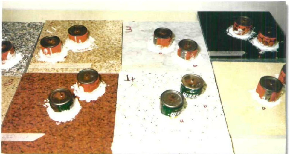
تجربة مخبرية مبسطة لقياس إشعاعات غاز الرادون في أنواع الرخام باستخدام كواشف الآثار النووية
