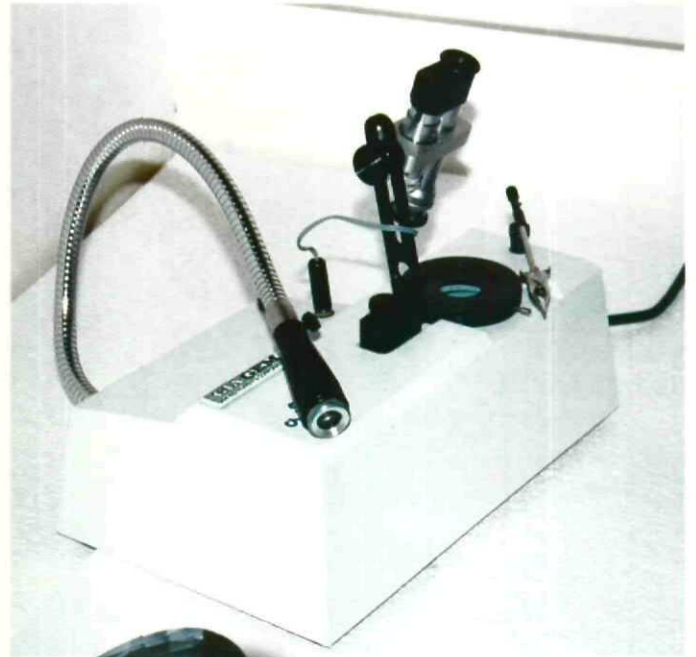
جهاز التحليل الطيفي للتمييز بين الأحجار المعالجة والأحجار الطبيعية.
