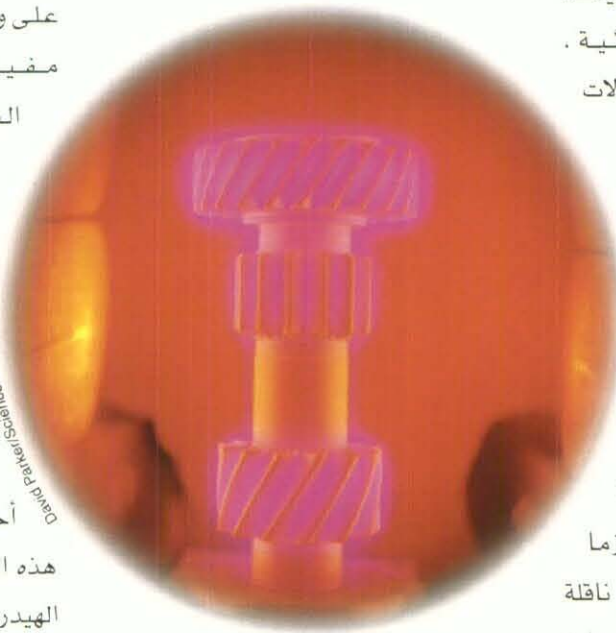
تدرس ناقل للحركة يمر بعانة «كربنة البلازما» . أي تحويل المادة المعدنية إلى مادة أكثر صلابة . حيث تتحلل الأيونات المنبعثة من بلازما المعدن لإنتاج نوع جديد من المعادن المختلفة النوعية .
