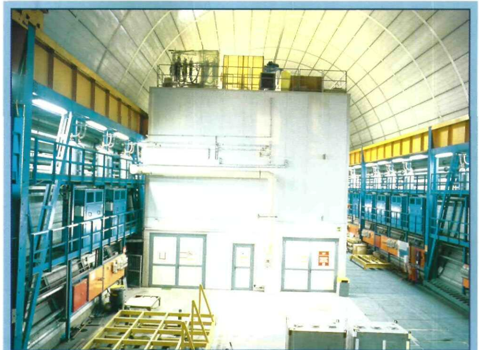
جانب من المنشآت التي تجري بين جنباتها التجربة الإيطالية المسماة «جالكس - Gallex»، في مختبر جران ساسو، الكائن تحت عمق ١٤٠٠ متر من الصخور، لإجراء البحوث حول (النيترينو) التي تتولد نتيجة تفاعلات الاندماج النووي في داخل الشمس.
