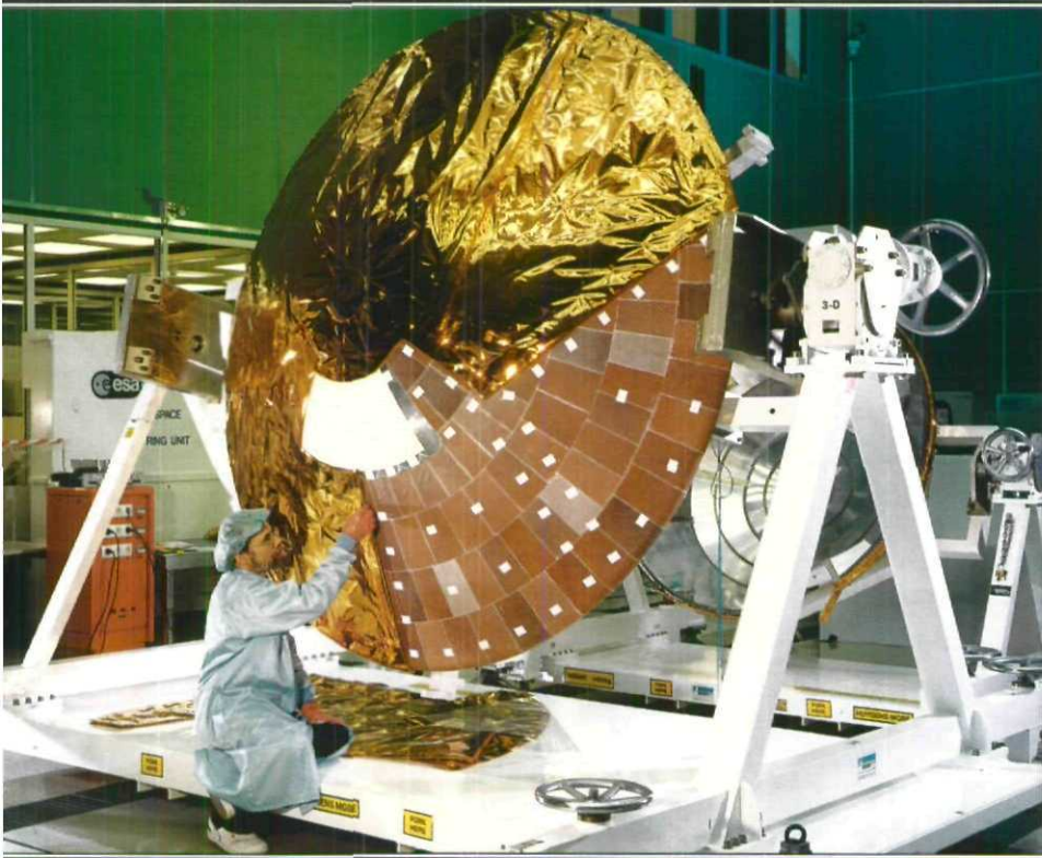
المسبار هايجنز أثناء تغليفه بطبقة من المادة العازلة.
