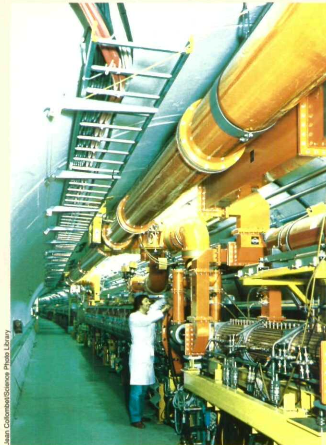
فني يعمل في مختبر فيزياء الجسيمات الأوروبي في جنيف. كما يظهر في الصورة النفق الذي يضم أنبوب الأشعة المحتوي على حزم البروتونات وضديدات البروتونات.
