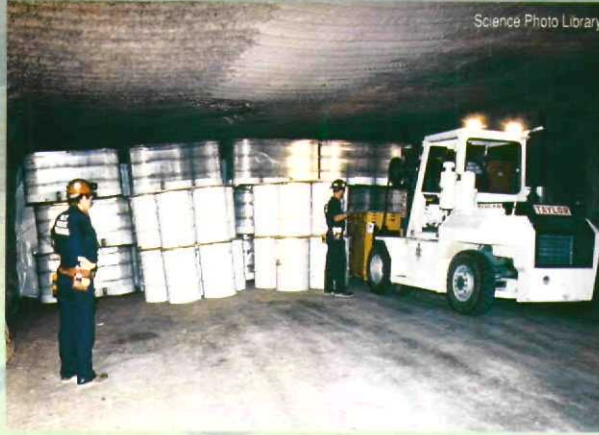
اسطوانات خاصة لتخزين النفائات النووية التي يتم التخلص منها وذلك عن طريق دفنها في أنفاق تحت الأرض يبلغ عمقها ٨٥٠ متراً.
