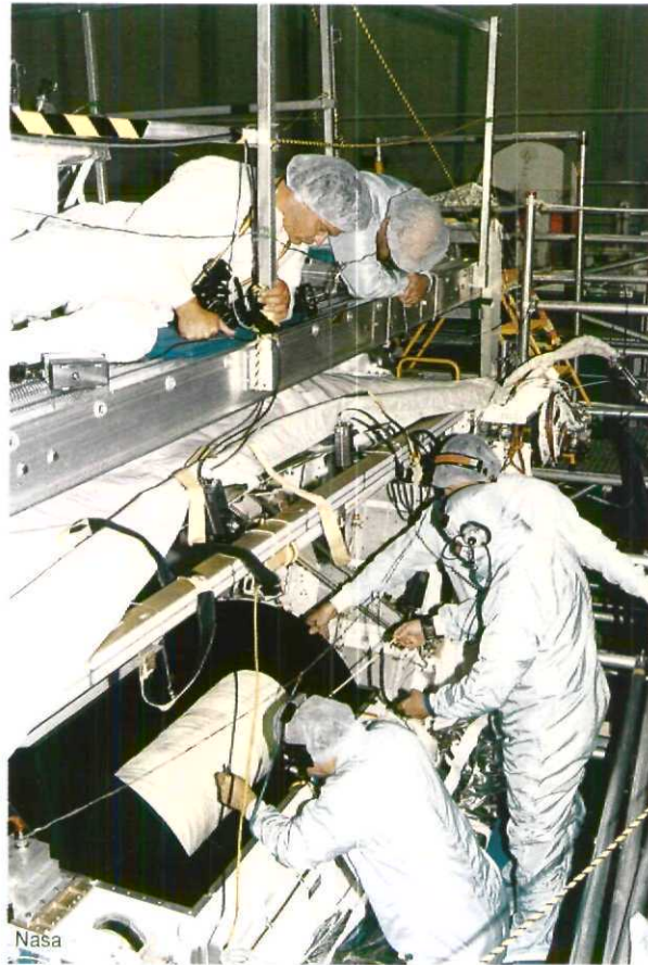
يقوم المهندسون والتقنيون بنشر ما طوله ٢٥٠ مترا من الطول التابع لجهاز القمر الصناعي (TSS) لفحصه والتأكد من خلوه من الغيوب الالتواء أو الانحناء ، وذلك تقاديا لحدوث اية مشاكل لاحقة عند اطلاقه في الفضاء .
