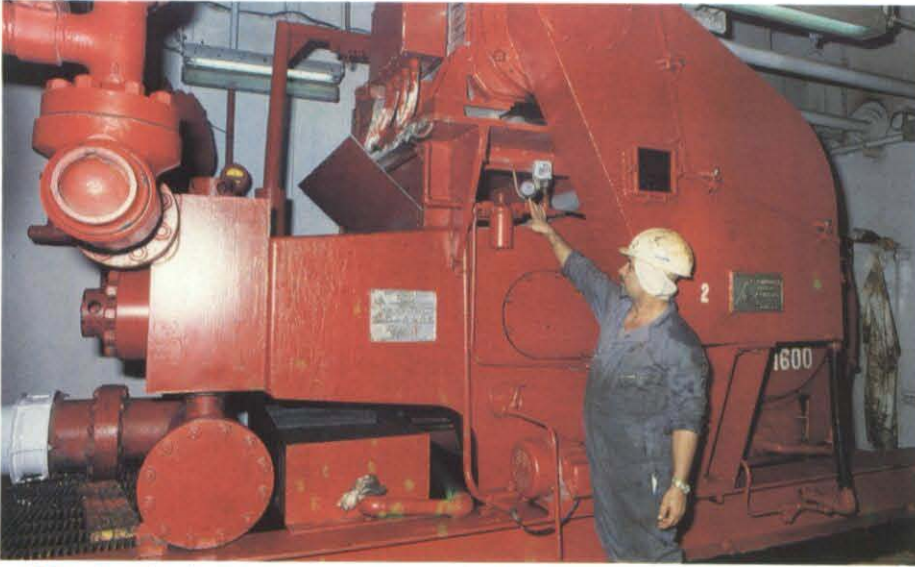
المسؤول عن مراقبة طين الحفر يفحص قياس الضغط في واحدة من مضختي دفع طين الحفر في DP3 .
