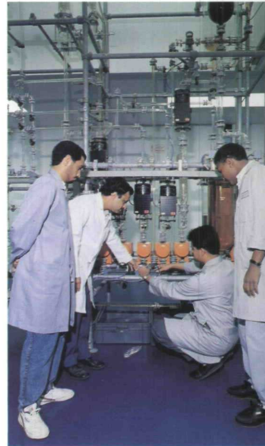
تهيء كلية ينبع الصناعية أجهزة مختلفة لبعض سير العمليات الصناعية . ويرى في الصورة عدد من الطلاب مع أستاذهم يراقبون عملية دخول الزيت الى جهاز مماثل لمعمل فرز الغاز عن الزيت .
