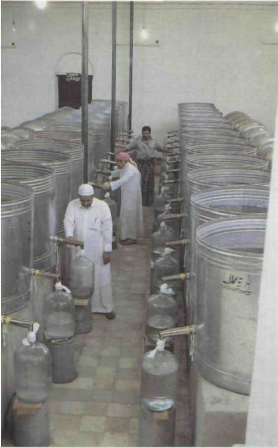
قنوات التبريد التي تعمل على تحويل البخار المتبخر بالتكثيف إلى ماء يجمع في قوارير زجاجية كبيرة .
