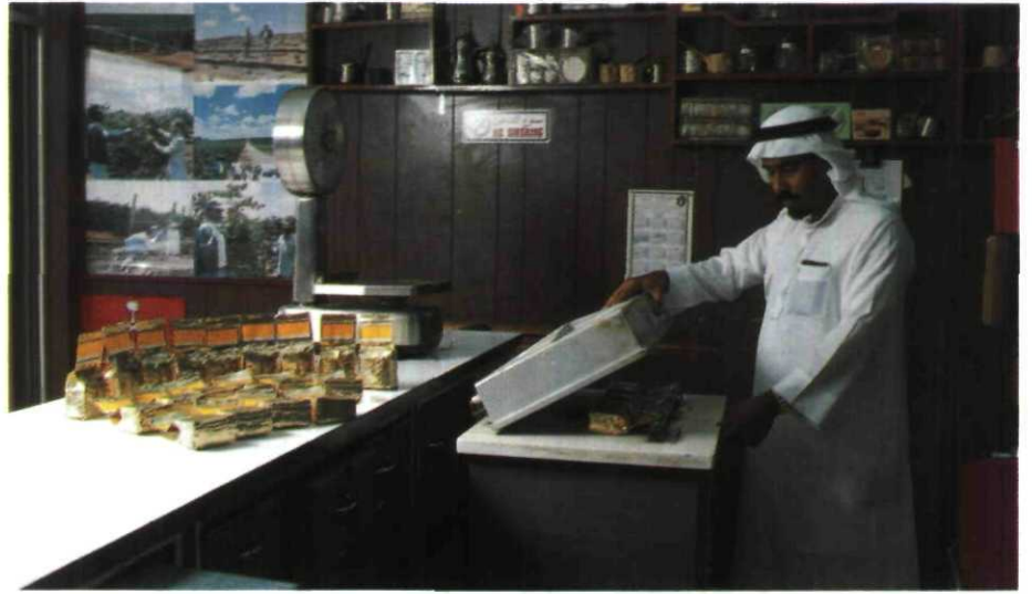
جهاز خاص يتم بواسطته تفريغ اكياس القهوة من الهواء بعد تعبئتها للمحافظة عليها لمدة اطول .
