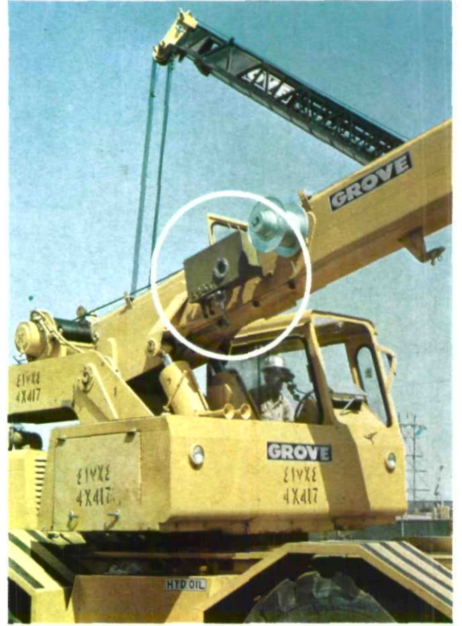
تضم وحدة الروافع عدداً من الروافع الحديثة ، وهذا احداها حيث يبدو جهاز السلامة الالكتروني مثبتاً على قائمتها .
