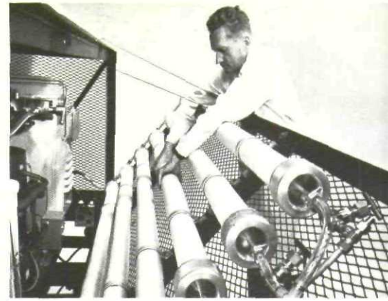
لمريقة «التنافذ العكسي» من بين الطرق التقليدية المستخدمة حالياً في عملية «الزلمحة - Desalination»
